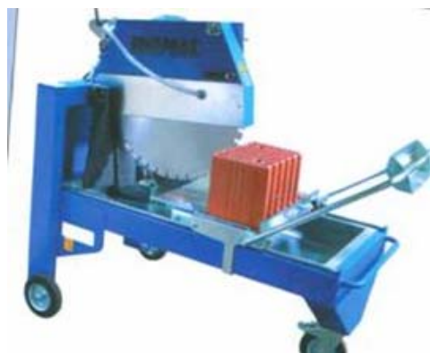
SL.4. STOLNA REZAČICA ZA REZANJE BLOKOVA I RUBNJAKA (LISSMAC DTS 271)
