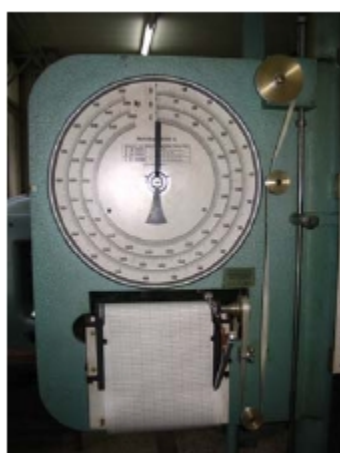
Dio za registrovanje sile i crtanje dijagrama zatezanja
