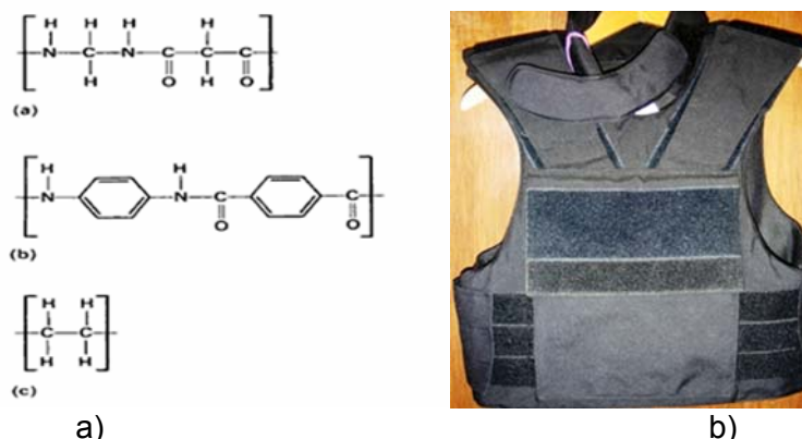
Slika 1.8 a) Molekularna struktura :najlon, aramid i polietilen b) primjena aramidnih vlaknana (Kevlar 49) u izradi zaštitne opreme
